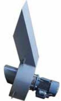
*Volute :* Acier galvanisé, soudée par point.*Turbine :* Turbine à pales embouties, acier galvanisé.*Moyeu :* Moyeu aluminium boulonné extérieur*Moteur :* Montage moteur sur colonnettes.
